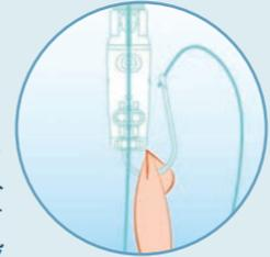
**i** 投縄時には餌の付いた釣り針がフックポッド内に収納され、針先とかえし（パーブ）が外に出ないようにしています。あらかじめ設定した水深に達すると圧力放出システムが働いてフックポッドが開き、餌の付いた釣り針が出てきます。
